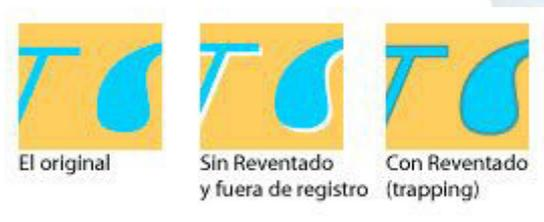
En imprenta, aplicar reventados (trapping) es una forma de ajustar cómo imprimen los colores de las diferentes planchas para corregir los defectos visuales que producirán los inevitables pequeños fallos en el registro de las planchas al imprimir.
