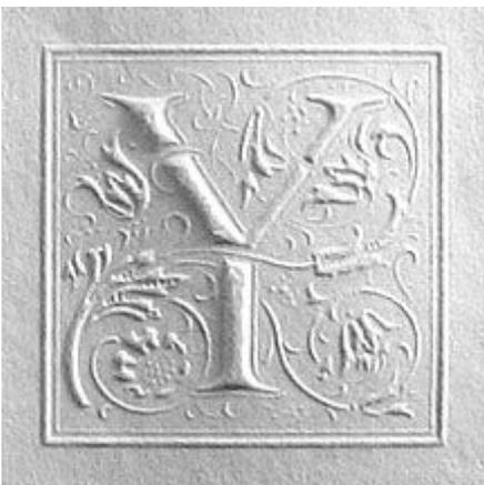
Técnica de impresión (o, más bien, de "acabado") que consiste en imprimir letras o imágenes mediante presión con un troquel y contra-troquel sin tinta ni barniz (por eso es "seco") sobre una superficie para dejar una marca en relieve (bajorrelieve o altorrelieve, dependiendo de la disposición de las piezas). En algunos casos, se añade a la vez calor.
